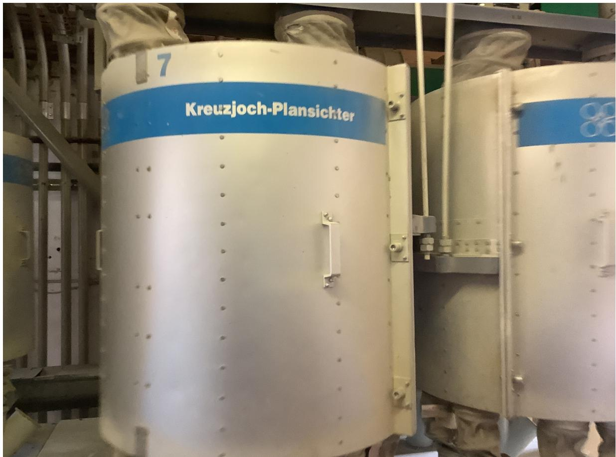
Das ist die Siebanlage. Darin sind Mehlsiebe. Die Siebanlage schüttelt sich. Dadurch wird das Mehl ganz fein gesiebt.
